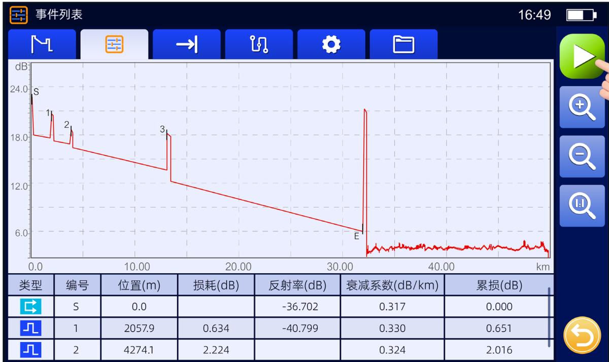
精确轨迹线显示，不错过任何事件，通过曲线了解光缆断裂、长度、弯曲、熔接点、连接头等损耗。
