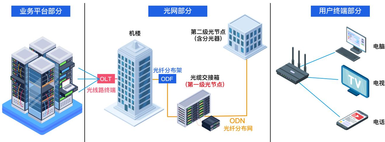
FTTx装维工程网络示意图：由业务平台、光网络、用户终端三大部分组成。
