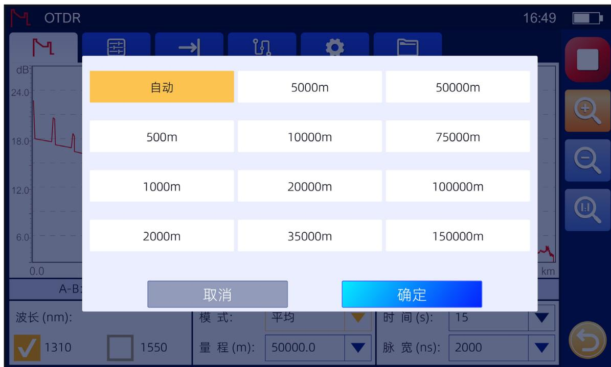
可手动设置采集参数，如范围或持续时间，也可以启用自动模式，根据光纤布线的长度和总损耗，无需繁琐操作，一键测试。
